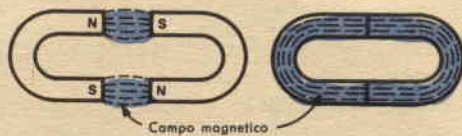
Fig. 3 - I poli magnetici sembrano scomparire quando due magneti a U sono avvicinati in questo modo.
